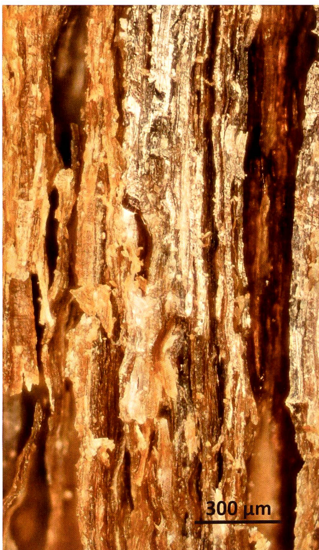
Fig. 13 Particolare della sezione longitudinale tangenziale del legno di Ornavasso. Mancano i grandi raggi midollari tipici della quercia: si tratta quasi certamente di legno di castagno ( Castanea sativa ).
