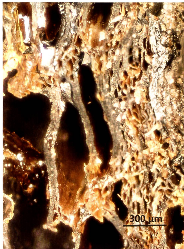
Fig. 12 Particolare della sezione trasversale del legno di Ornavasso. I grandi vasi della zona iniziale, da ovali sono diventati a fessura per effetto del ritiro dimensionale e sono seguiti in alto dai vasi più piccoli e tondeggianti del legno tardivo (cfr. testo).
