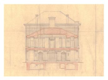
Abb. 10 Schnitt Nord-Süd gegen Ost durch die Passage. Im Erdgeschoss die Durchgangssituation mit Zugang zu Vestibül und Parkett des Musiksaals. Im Obergeschoss das Foyer mit Zugang zur Galerie des Musiksaals, um 1874/75 (Ausschnitt). Planzeichnung von Johann Jacob Stehlin (1826–1894). Tusche, Bleistift und Farbstift auf Papier, 64,5 × 95 cm. Universitätsbibliothek Basel, NL 107 II B c.
