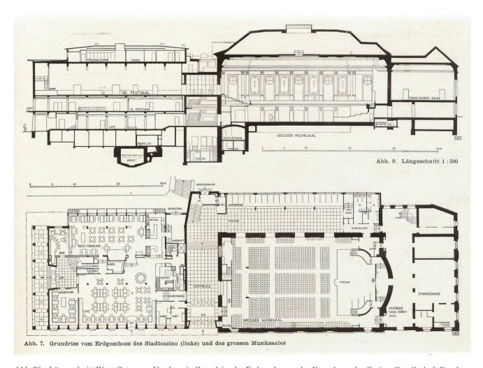
Abb. 30 Längsschnitt West-Ost gegen Nord sowie Grundriss des Erdgeschosses des Komplexes der Casino-Gesellschaft Basel am Steinenberg, 1944. Abbildung aus: Schweizerische Bauzeitung, Bd. 123, 1944, S. 31, Abb. 9, 7. Foto: Universitätsbibliothek Basel 2017.
