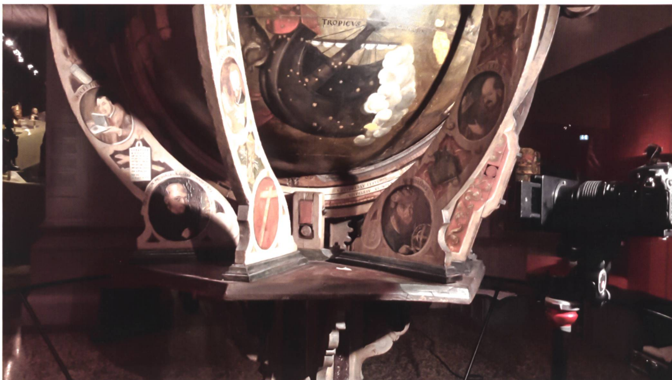
Abb. 9.2 Digitale Kamera mit vorgesetztem Filter für die Infrarot-Reflektografie durch Peter Wyer, Schweizerisches Nationalmuseum, vor der alten Schauseite des Globusgestells mit den drei gleichzeitig sichtbaren Pergament-Medaillons.
