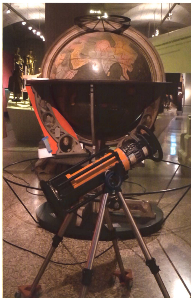
Abb. 9.1 Mobile Röntgenröhre für die Radiografie durch Thomas Becker, Art Conservation, im Auftrag der Stiftsbibliothek St. Gallen. Ein Röntgenfilm (rot) befindet sich auf der Rückseite der Korbstrebe.
