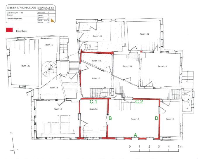
Abb. 1 Grundriss der beiden Stuben vom Haus am Gütschweg 11/13 mit den definierten Wand- und Raumbezeichnungen.
