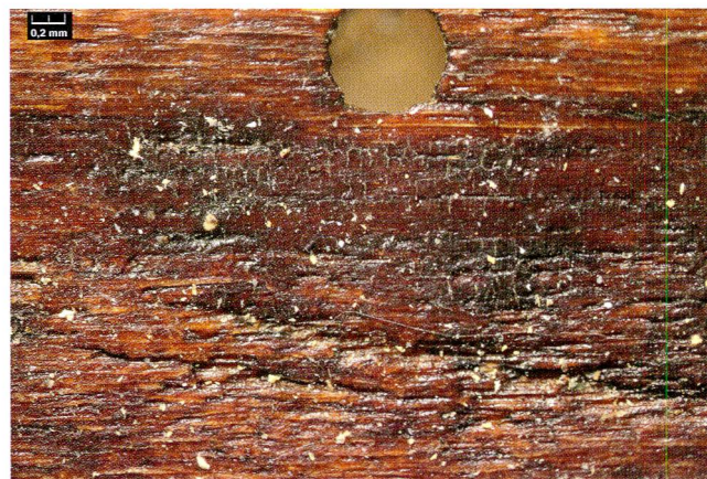
Abb.13 Der bauzeitliche Anstrich bedeckt die Frassränder des Wurmlöchs. Oberfläche in 50-facher Vergrösserung, Auflicht.
