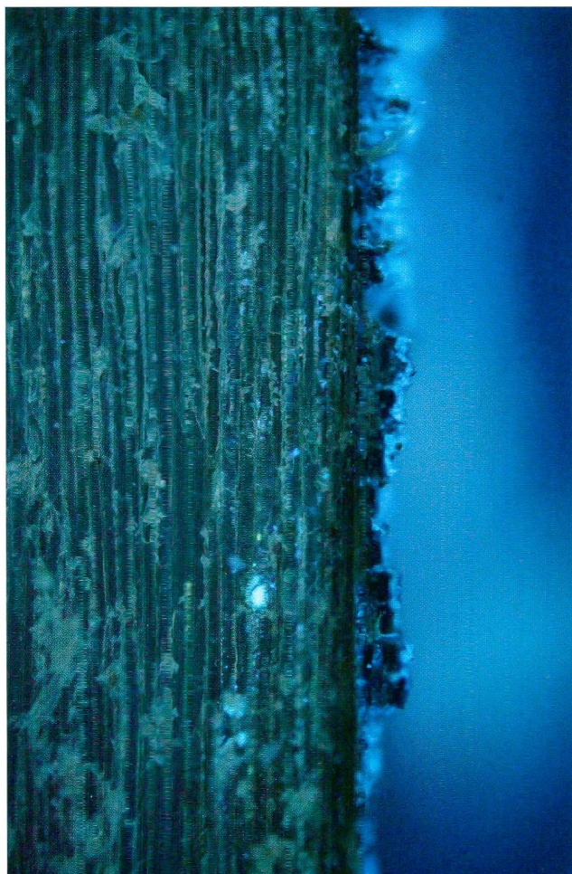
Abb.8 Gleicher Querschnitt wie in Abb.7. Aus der Oberfläche ist noch eine hell fluoreszierende Schicht zu sehen, die von einem Wachs stammen kann (Spritzer von Kerzen?). Querschnitt in 200-facher Vergrösserung, UV-Licht.
