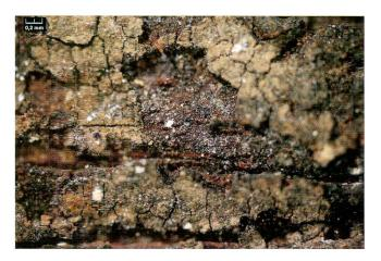
Abb. 10 Westwand von 1280 (d), Probe mit zwei Anstrichen, der obere mit deutlichem Craquelé. Schwyz, Dorfbach 8, EG. Oberfläche in 50-facher Vergrösserung, Auflicht.
