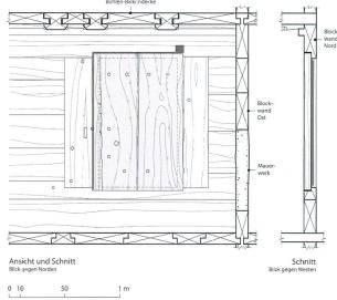
Abb. 26 Haus Gütschweg 11. Kleine Stube. Blick gegen Norden (oben), Türöffnung der Nordwand, Ansicht und Schnitt.
