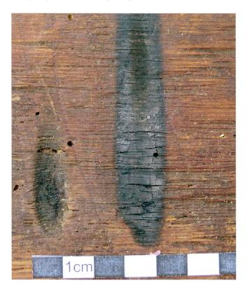
Abb.12 Flammenförmige Brandspur. Originale Brandspur (links), nachgestellte Brandspur (rechts). Hierzu wurde 2 Minuten lang eine Kerze an die Holzoberfläche gehalten.
