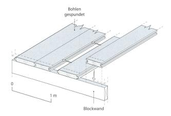
Abb.5 Gespundete Bohlen (Nut-Kamm-Verbindung).
