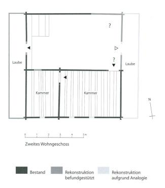
Abb. 24 Haus Gütschweg 11. Rekonstruierter Grundriss des ersten und zweiten Wohngeschosses.
