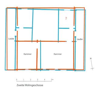
Abb. 27 Vergleich der Grundrisse der beiden Häuser Gütschweg 19 (blau, gespiegelt) und Gütschweg 11 (rot). Erstaunlich sind die Ähnlichkeiten in der Anlage, vgl. Lage des Lukenfensters in der grossen Stube.
