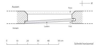
Abb. 9 Haus Gütschweg 19. Lukenfenster. Ansicht Westfassade (oben), Innenwand (Mitte) und Horizontalschnitt (unten).
