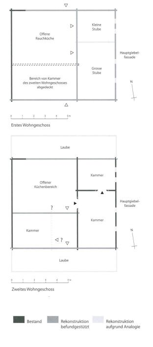
Abb.16 Dorfbachstrasse 8. Rekonstruierter Grundriss des ersten und zweiten Wohngeschosses.
