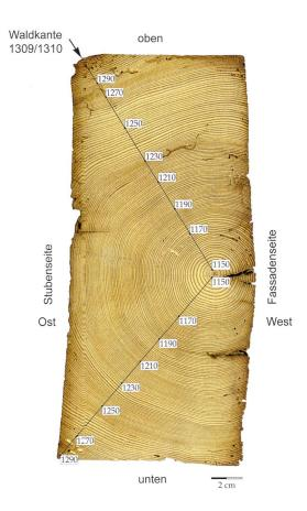
Abb. 13 Haus Gütschweg 11. Präparierter Balkenabschnitt der Westfassade mit den Jahrringen vom Wachstumsbeginn im Jahr 1150 bis zum Fällen im Winterhalbjahr 1309/10.
