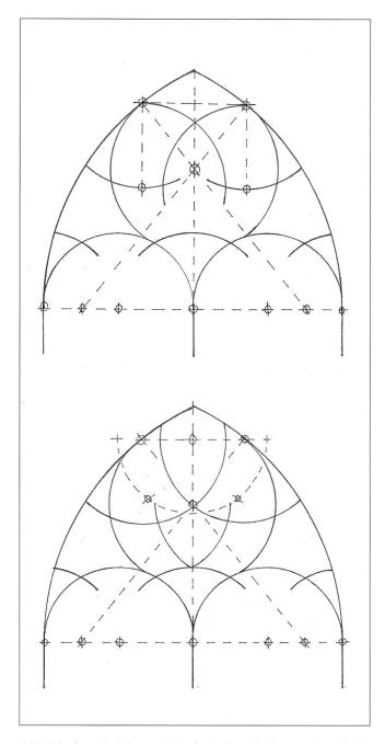
Abb.25 Stürvis, Masswerk 1, a) planimetrische Analyse, b) virtuelle Variante.
