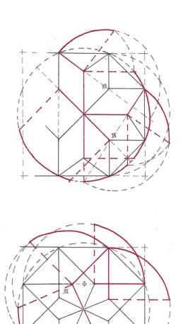
Abb. 4 Stern- und Rautengewölbe konstruiert in der sogenannten Kugelprojektion, nach Werner Müller (vgl. Anm. 13).
