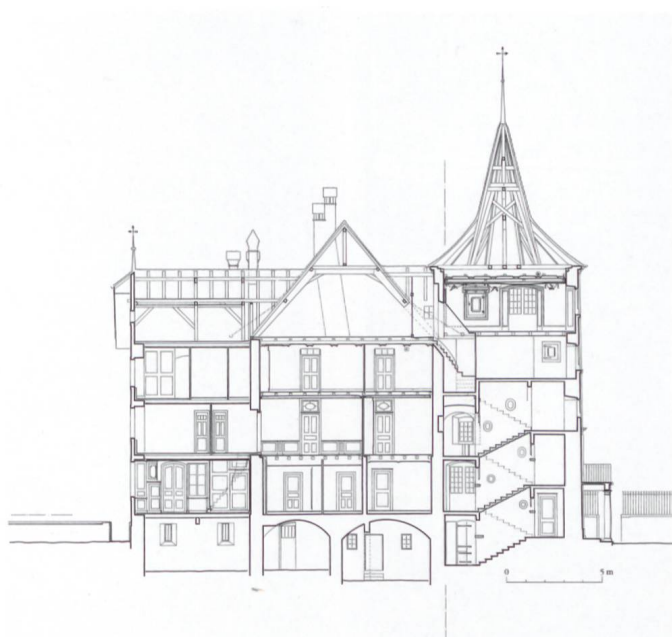
Fig. 9 Moudon, maison seigneuriale de Forel. Coupe. Le corps de logis principal a conservé son gros œuvre et sa charpente de 1619, mais le sol du dernier étage a été surélevé en 1669–1671, lorsque l'on a surélevé également la tour d'escalier. Dessin René Tosti 1982.
