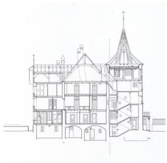
Fig. 9 Moudon, maison seigneuriale de Forel. Coupe. Le corps de logis principal a conservé son gros œuvre et sa charpente de 1619, mais le sol du dernier étage a été surélevé en 1669–1671, lorsque l'on a surélevé également la tour d'escalier. Dessin René Tosti 1982.
