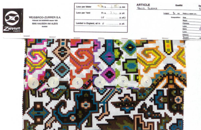
Abb.31 Archiv-Nr.376: Schafgewebe, Köperbindung, Druck. Tricel (Triacetat), 1960–1980.
