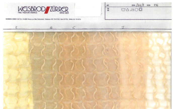
Abb.35 Archiv-Nr.602: Schaftgewebe, Leinwandbindung, Lancé. Keine Materialangaben, 1980–2005.
