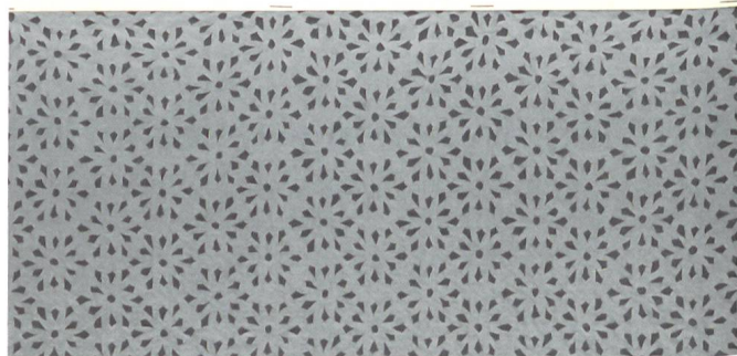
Abb.2 Archiv-Nr.81: Schaffgewebe, Leinwandbindung, gestanz. Nylon (Polyamid), ca. 1940.
