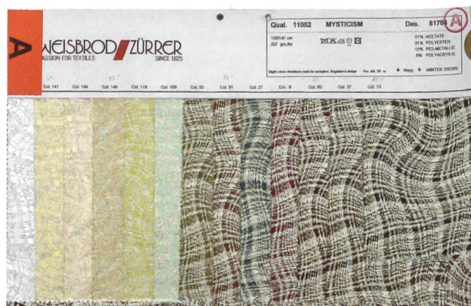
Abb.12 Archiv-Nr.219: Jacquardgewebe, Doubleface, Leinwandbindung, Atlasbindung. Materialmischung (51 % Acetat, 31 % Polyester, 12 % Lurex, 6 % Polyacryl), 2001/02.
