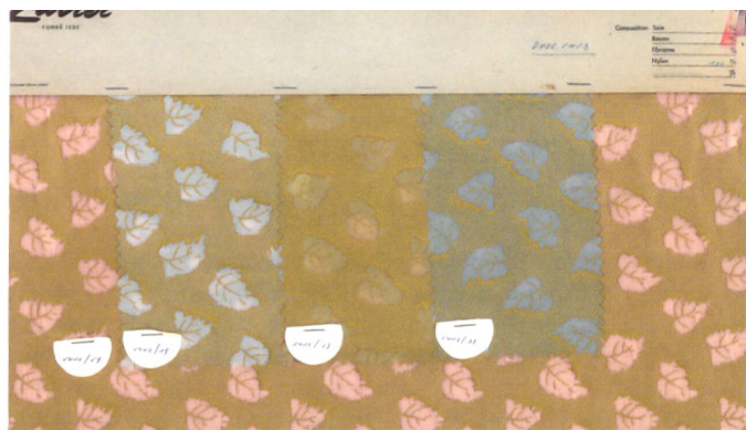
Abb.1 Archiv-Nr.351: Schaffgewebe, Leinwandbindung, Druck. Nylon (Polyamid), ca. 1940.
