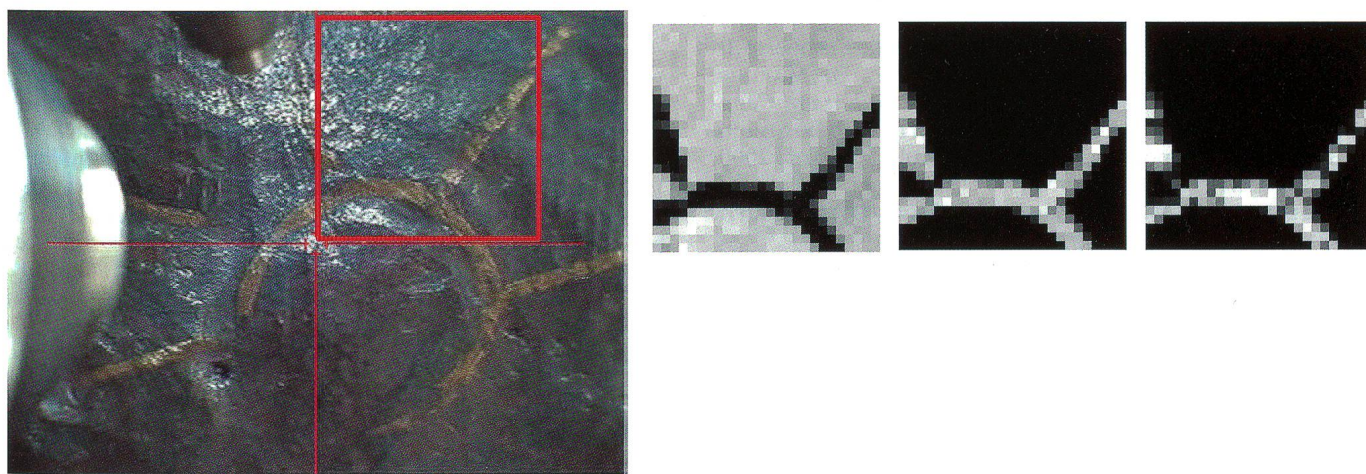
Fig. 10 Distribuzione di ferro, rame e zinco. I toni di grigio corrispondono alle concentrazioni presenti. Bianco: concentrazione elevata. Nero: bassa concentrazione.
