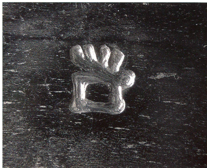
Abb. 3 Nachbau des Oberwiler Degens, 2013. Mit Zinn ausgefüllte Schmiedemarke.
