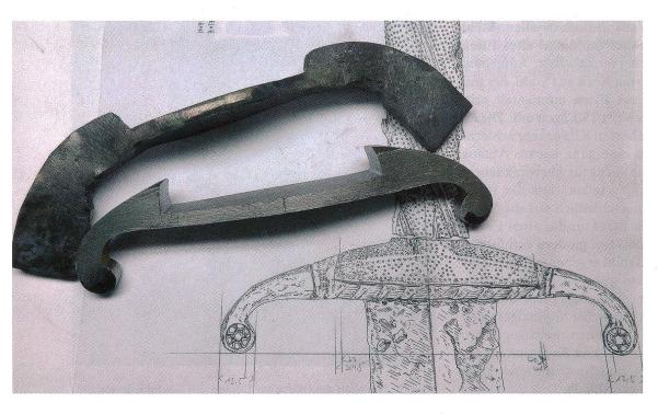
Abb. 4 Nachbau des Oberwiler Degens, 2013. Zwischenstufen des Parierelements.
