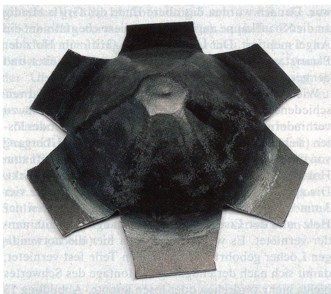
Abb.8 Nachbau des Oberwiler Degens, 2013. Zwischenstufe Knaufkappe.
