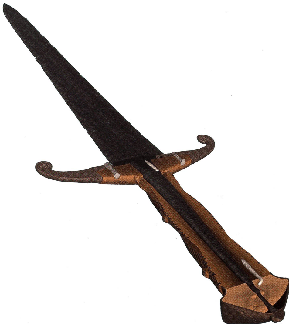
Abb.16 Degen aus Oberwil, Rämatt ZG, zweite Hälfte 15. Jahrhundert. 3D-Visualisierung einer kombinierten Neutronen- und Röntgentomografie. Die Holzdetails stammen aus dem Neutronendatensatz, die Informationen über die dekorativen Zinnamalgamelemente lieferte hauptsächlich der Röntgendatensatz. Die Farben entsprechen nicht den vorliegenden Materialien, sondern dienen nur zur besseren Unterscheidung der verschiedenen Konstruktionselemente.
