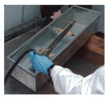
Abb. 8 Aluminiumgefäss mit zwei Querstangen, auf welchen der Degen ruht. Die Lösungsmittel werden durch einen geerdeten Schlauch eingebracht.
