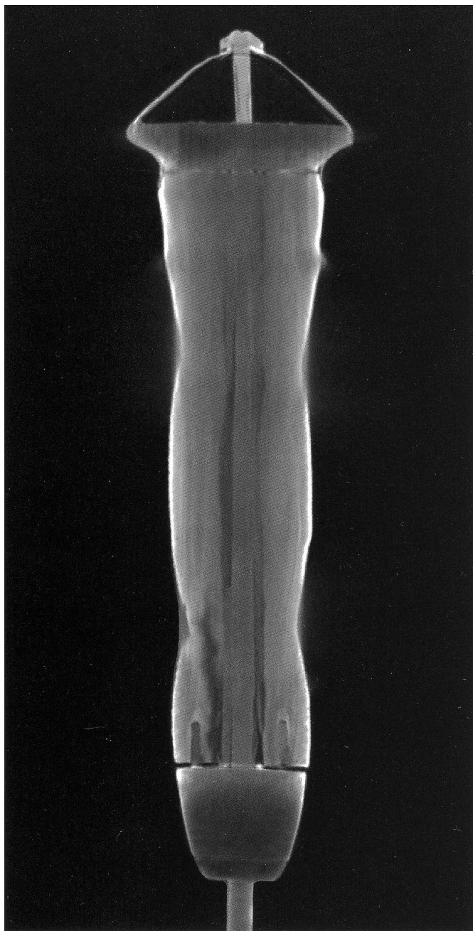
Abb. 6 Degen aus Oberwil, Rämatt ZG, zweite Hälfte 15. Jahrhundert. Neutronentomografie der Knaufkappe mit den beiden Metallstiften zwischen Griffholz und Griffbasis. Amt für Denkmalpflege und Archäologie, Direktion des Innern, Kanton Zug.
