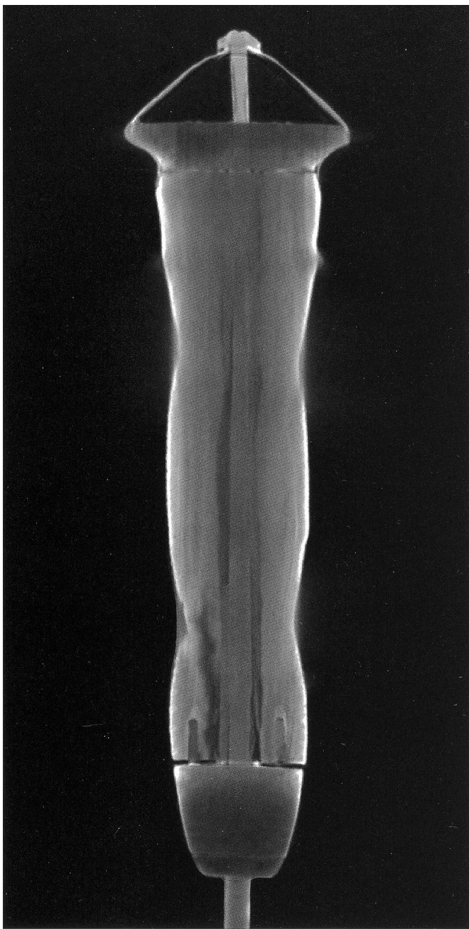
Abb. 6 Degen aus Oberwil, Räbmatt ZG, zweite Hälfte 15. Jahrhundert. Neutronentomografie der Knaufkappe mit den beiden Metallstiften zwischen Griffholz und Griffbasis. Amt für Denkmalpflege und Archäologie, Direktion des Innern, Kanton Zug.
