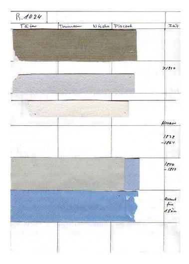
Fig. 3 Exemple de relevé effectué dans la salle à manger de marbre lors du sondage des murs entrepris entre 1982 et 1984. Musée national suisse.
