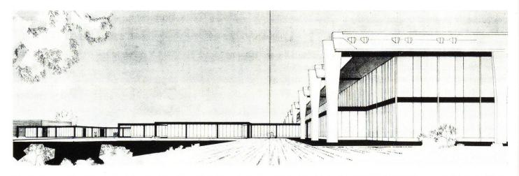
Fig. 8 Perspective d'une « unité organique de production » de l'ensemble industriel de Scarmagno, Marco Zanuso et Eduardo Vittoria, 1967. Au premier plan à droite le bâtiment de production à structure en béton armé, à l'arrière plan les corps de services à structure métallique.
