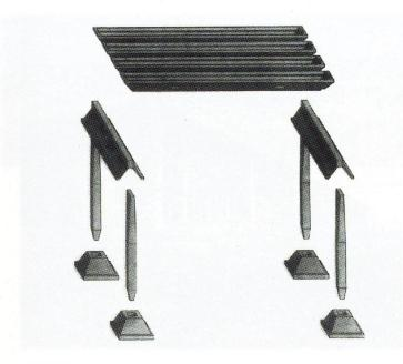
Fig. 9 La structure porteuse de l'ensemble industriel de Scarmagno, Marco Zanuso et Eduardo Vittoria, 1967. Axonométrie illustrant les quatre éléments principaux : plinthe, pilier, poutre principale à section en Y et poutre secondaire à section triangulaire creuse.
