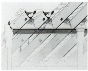
Fig. 12 L'intégration des réseaux à la structure porteuse, Marco Zanuso et Eduardo Vittoria, 1967. Axonométrie vue du bas.
