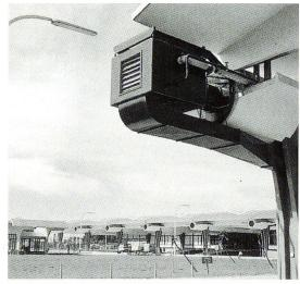
Fig. 6 Usines Olivetti à Buenos Aires en Argentine, Marco Zanuso, 1954–1956. Intégration des réseaux aux poutres creuses.
