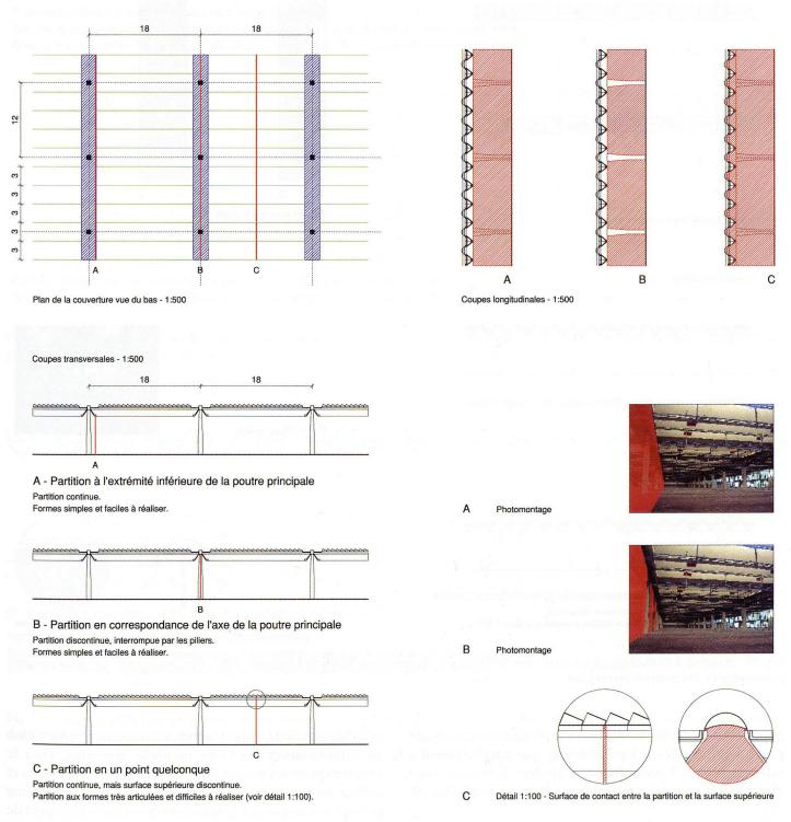
Fig. 18 Analyse à l'échelle architecturale des bâtiments de Scarmagno, Roberta Grignolo, 2002. Positionnement de partitions parallèles aux poutres principales.
