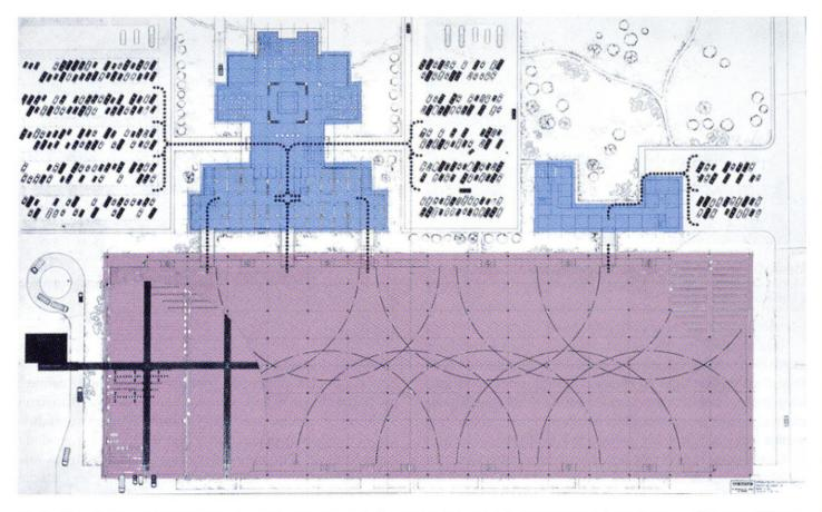
Fig. 7 Plan d'une « unité organique de production » type de l'ensemble industriel de Scarmagno, Marco Zanuso et Eduardo Vittoria, 1967. En bas le bâtiment de production sur grille 12 × 18 m, en haut les bâtiments annexes logeant les services : dans le corps de gauche la cantine et les vestiaires, dans le corps de droite les bureaux.
