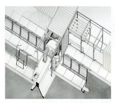
Fig. 10 Intégration des réseaux à la structure porteuse dans l'ensemble industriel de Scarmagno, Marco Zanuso et Eduardo Vittoria, 1967. Axonométrie vue du haut. Les installations courent au niveau de la toiture dans des dorsales techniques au-dessus des poutres principales, puis elles distribuent l'air à l'intérieur grâce aux poutres secondaires creuses, qui sont utilisées comme canalisations.
