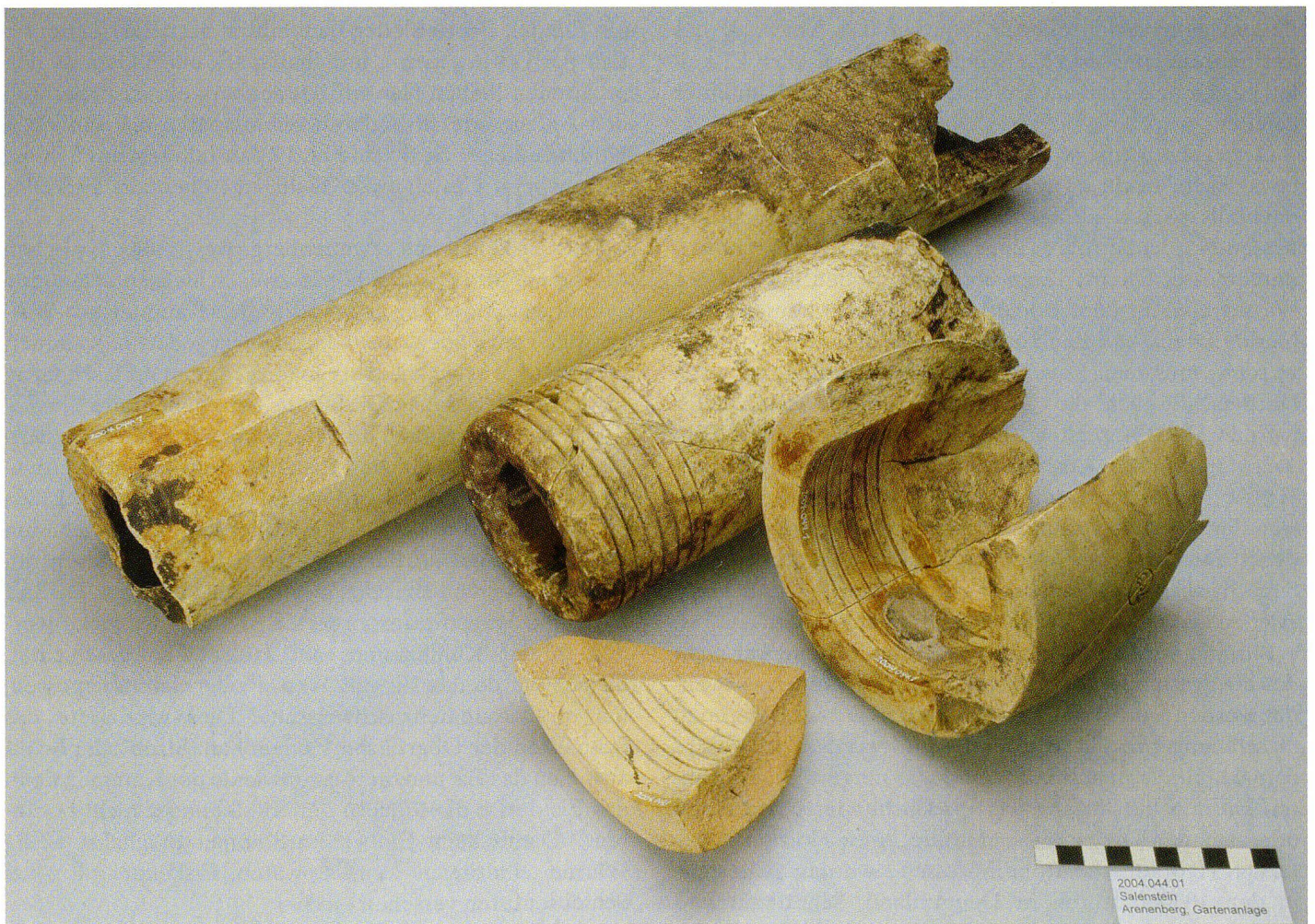
Abb. 15 Springbrunnen. Tönerne Muffenröhren der Abwasserleitung.
