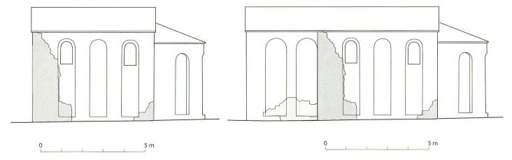
Abb. 4 Ascona, San Sebastiano. Kapelle I/Etappe 1, Südansicht, rekonstruiert aufgrund der Bauuntersuchungsdokumentation.
