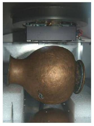
Fig. 7 Messung eines römischen Bronzebechers in der Probekammer des Geräts Eagle III RFA XXL.
