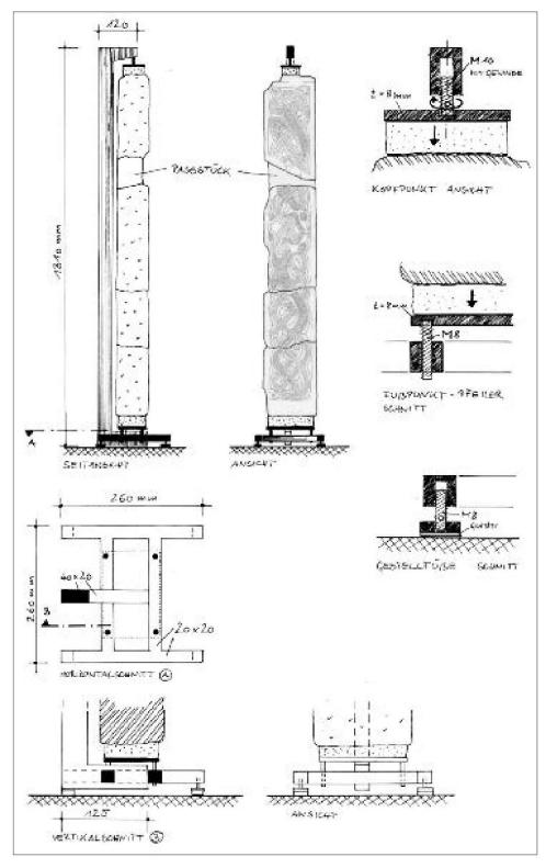
Abb. 4 Müstair, Marmorpfosten Pfo12. Konstruktionszeichnungen des Befestigungsgestells, o.M.
