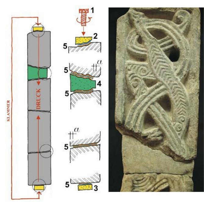
Abb. 2 Müstair, Befestigungs- und Aufstellungsprinzip des Marmorpfostens Pfo12. Schemaskizze. 1: Feststellschraube; 2: Oberes Passstück aus Kunstmarmor; 3: Unteres Passstück aus Kunstmarmor; 4: Zwischenteil als Passstück aus Kunstmarmor; 5: Trennlagen aus 1 mm starkem Walzblei und mehrlagigem Japanpapier; a: Randabstand beachten.
