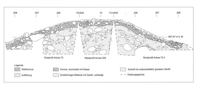
Abb. 9 Calonico «Castello». Aufbau des Hügels, dokumentiert in Profilzeichnungen. M 1:50.
