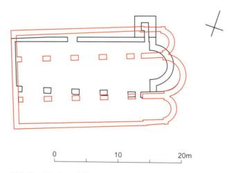
Abb. 31 Martigny (VS), Pfarrkirche. Geplante, aber nicht ausgeführte dreischiffige Kirche (rot), Rekonstruktionsversuch. Die Abstände der Pfeiler entsprechen denen der vollendeten Kirche VIa, die Breite des Hauptchores dem Chor von Bauphase VIb. Schwarz: realisierter Bau VIa.
