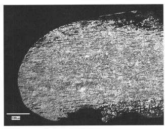
La microsection permet également d'observer une importante dégradation du métal, tant en face externe qu'en face interne de la feuille. Cette dégradation est liée à l'altération préférentielle de la phase riche en cuivre de l'alliage, sous la surface dorée.
