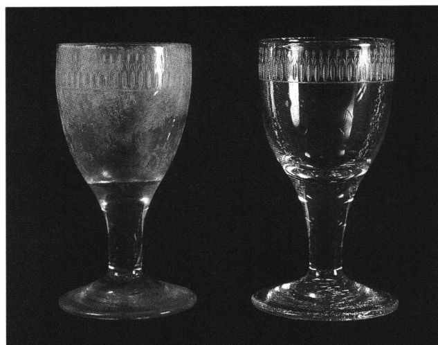
Abb. 8 Zwei Kelchgläser, 1. H. 19. Jh., Höhe 11.5 cm. Instabiles Glas; links in ungereinigtem Zustand: weissliche, ursprünglich wohl flächendeckende Ablagerungen auf der gesamten Glasoberfläche, rechts in gereinigtem Zustand: Das Glas gewinnt seine ursprüngliche Transparenz zurück. Zürich, Schweizerisches Landesmuseum.
