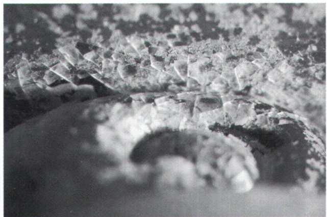
Abb. 16 Detailansicht des Trinkglases von Abb. 15. Regelrecht abplatzende Gelschichtschollen. Breite des Ausschnitts ca. 7 mm.
