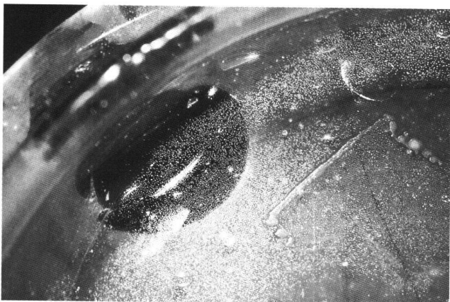
Abb. 3 Detailansicht der Fusschale von Abb. 2; feinste Tröpfchen an der Innenwandung des Deckels. Breite des Ausschnitts ca. 35 mm.
