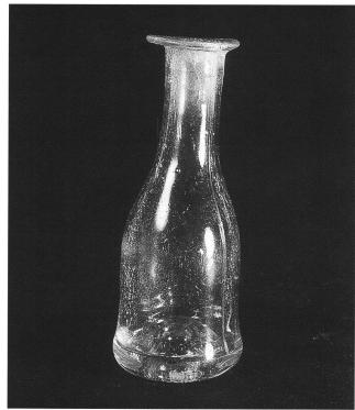
Abb. 9 Kugelflasche, 1787, Höhe 32 cm. Angegriffenes Glas; sehr feines, vorwiegend geradlinig verlaufendes und langgezogenes Rissmuster; weissliche, flächendeckende Ablagerungen über dem ausgebildeten Rissnetzwerk. Zürich, Schweizerisches Landesmuseum.
