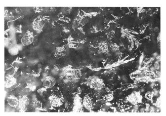
Abb. 7 Detailansicht des Tropfenfängers von Abb. 6; nadelige Natriumformiatkristalle auf der Glasoberfläche. Breite des Ausschnitts ca. 7 mm.
