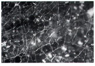
Abb. 20 Rissbildung an korrodiertem Originalglas. Breite des Ausschnitts ca. 7 mm.
