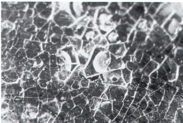
Abb. 14 Detailansicht des Deckels von Abb. 13. Einzelne Gelschichtscholle hebt sich von der Glasoberfläche ab. Breite des Ausschnitts ca. 7 mm.
