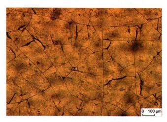
Abb. 19 Rissbildung an bewittertem Modellglas. Der Oberflächenzustand des Sensors wurde am Lichtmikroskop bei einer 100-fachen Standardvergrösserung und polarisiertem Mischlicht erfasst.
