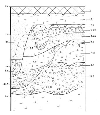
Fig. 2 Schéma de la stratigraphie type du site. 1: humus; 2: limons d'inondation avec méandre sub-récent; 3.1: horizon mérovingien; 4.1: horizon protohistorique; 5: graviers de fond de vallée.
