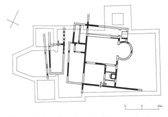
Abb. 3b Martigny (VS), Pfarrkirche Notre-Dame-des-Champs. Schematischer Grundriss des christlichen Sakralbaus mit verbreitertem Schiff und Baptisterium südlich des Schiffs, drittes Viertel 4. Jahrhundert. Schwarz: nachgewiesene Mauerzüge. Pfeile: nachgewiesene Durchgänge.
