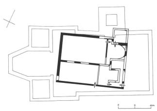
Abb. 3c Martigny (VS), Pfarrkirche Notre-Dame-des-Champs. Schematischer Grundriss der Doppelkirche, 5. Jahrhundert. Schwarz: nachgewiesene Mauerzüge. Pfeile: nachgewiesene Durchgänge.
