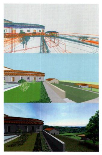
Abb. 9 Drei Schritte zum Modell. 1: Das nach den Originalmassen konstruierte Drahtgittermodell. 2: Festlegung der Oberflächen inkl. Licht- und Schattenspiel. 3: Definition der Oberflächenstrukturen und Montage des reellen Hintergrundes. Als Beispiel dient der stark ergänzte Gutshof unter dem römischen Kastell von Pfäffikon-Irgenhausen.
