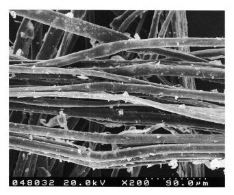
Abb. 7 Lein mit Klopfholz bearbeitet, Probe A.
