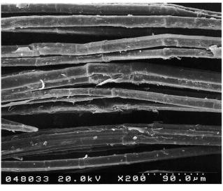
Abb. 8 Lein mit Klopfholz gebrochen, Probe I.
