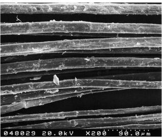
Abb. 10 Lein mit «Fingermethode» gebrochen, Probe D.
