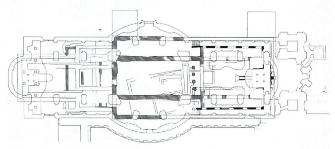
Abb. 3 St. Gallen, Kathedrale, ehemalige Klosterkirche. Hervorgehoben ist der Grundriss des Gozbertbaues (Abt Gozbert 816–837). Schwarz das Aufgehende, schraffiert sind Fundamente bzw. Fundamentgruben. Weitere ältere Mauern mit Konturen angedeutet.
