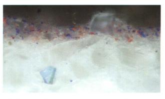
Abb. 9 Querschliff einer Probe (Nr. 40) aus dem Wandgemälde, Mittelbild mit sehr dünnem, lasierenden Farbauftrag. Der Übergang der pigmentierten Schicht (Eisenoxidrot, synthetischer Ultramarin) in den Feinputz deutet auf Fresko-Technik hin; eine Sinterschicht fehlt allerdings. Mikroskopisches Bild im Auflicht, Bildbreite =  $0.27~\mathrm{mm}$ .
