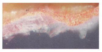
Abb. 11 Querschliff einer Probe (Nr. 26) aus dem Wandgemälde, Mittelbild (Fahne mit Lilien oben links). Deckende rotorange Malschicht mit Zinnober, deren deutliche Grenze zum Putzträger auf Auftrag auf den getrockneten Putz hindeutet. Hellgelbe Übermalung (Lilie) mit Calcit, wenig Gips, wenig Ocker und Cadmiumgelb. Mikroskopisches Bild im Auflicht, Bildbreite = 0,27 mm.
