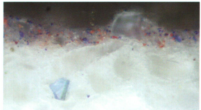
Abb. 9 Querschliff einer Probe (Nr. 40) aus dem Wandgemälde, Mittelbild mit sehr dünnem, lasierendem Farbauftrag. Der Übergang der pigmentierten Schicht (Eisenoxidrot, synthetischer Ultramarin) in den Feinputz deutet auf Fresko-Technik hin; eine Sinterschicht fehlt allerdings. Mikroskopisches Bild im Auflicht, Bildbreite = 0,27 mm.
