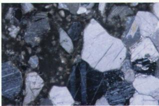
Abb. 5 Dünnschliff einer Feinputzprobe (Nr. 2) aus dem Wandgemälde, Mittelbild. Die Zuschlagskörner sind relativ grosse Calcitkristalle, wahrscheinlich Marmorsand. Mikroskopisches Bild im polarisierten Durchlicht (Xpol), Bildbreite = 1,4 mm.
