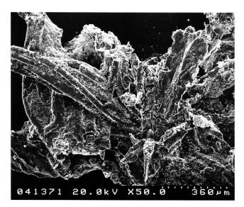
Abb. 5 Mit Konservierungsmittel bedecktes Textilfragment. REM-Foto.
