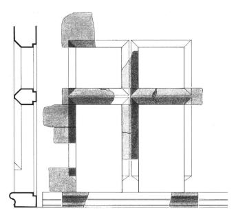
Fig. 9 Restitution d'une fenêtre gothique en molasse, à croisée avec mouluration en fort chanfrein et tablette moulurée en tore, XVe siècle. En foncé, les fragments retrouvés. Hauteur totale du vide de jour: 1,93 m.
