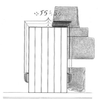
Fig. 11 Restitution d'une fenêtre en molasse moulurée en gorge amortie sur congé torsadé et résillé. Seconde moitié du XVI<sup>e</sup> siècle. Hauteur du vide de jour: 1,08 m.
