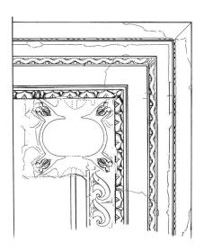
Fig. 5 Restitution du portique Renaissance, à bucrane sur colonnes ovales. Largeur de la colonne: 35 cm.
