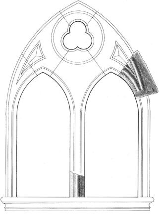
Fig. 8 Restitution d'une fenêtre à remplage gothique en calcaire jaune, avec mouluration en tore, fin du XIII° – début du XIV° siècle. En foncé, les fragments retrouvés. Hauteur du vide de jour des lancettes: 1,20 m.
