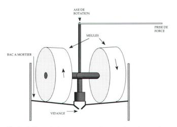
Fig. 8 Schéma de fonctionnement d'une *molazza*: les meules, solidaires avec l'axe de rotation entraîné par la prise de force, pétrissent la charge et la chaux dans le bac à mortier, qui peut être vidangé par le bas.
