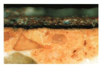
Fig. 11 Saint-Antoine, fragment 19, grain de raisin mauve sur fond noir appliqués sur une couche de tuileau, stratigraphie. Les surfaces de l'intonaco, imprégné de tuileau, et du fond noir ont été particulièrement bien lissées. Microscope optique, gross. sur dia  $24 \times 36$  mm: 65 fois.
