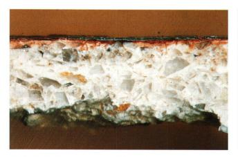
Fig. 9 Saint-Antoine, fragment 22, bordure verte sur fond rouge appliqués sur une fine couche de tuileau, stratigraphie. Démonstration de la différence de finesse de la charge pouzzolanique par rapport à la charge inerte. Macroscope, gross. sur dia 24 × 36 mm: 4 fois.
