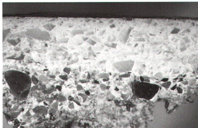
Fig. 10 Saint-Antoine, fragment 18, fond noir sur une fine couche de tuileau, stratigraphie. Comparaison de la granulométrie des charges du mediocrius et du subtilius . Macroscopie, gross. sur dia 24 x 36 mm: 2,5 fois.
