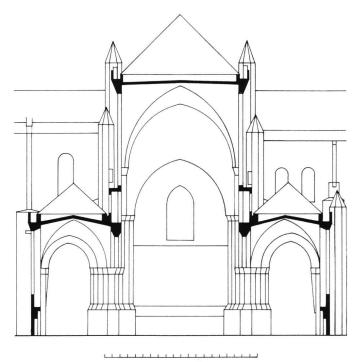
Fig. 7 Nef de la cathédrale de Strasbourg avant 1331: coupe transversale de la première travée orientale (reconstruction F. ZSCHOKKE, 1989).
