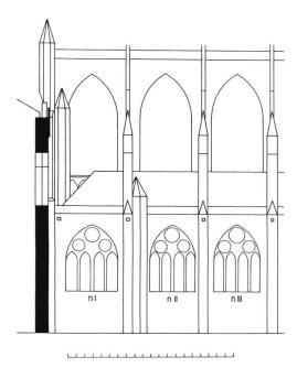
Fig. 8 Nef de la cathédrale de Strasbourg avant 1331, côté nord: élévation extérieure des trois premières travées orientales (reconstruction F. ZSCHOKKE, 1989).
