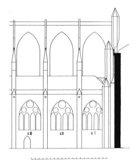
Fig. 9 Nef de la cathédrale de Strasbourg avant 1331, côté sud: élévation extérieure des trois premières travées orientales (reconstruction F. ZSCHOKKE, 1989).
