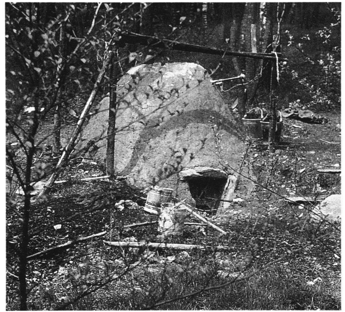
Abb. 50 Nachgebauter Rennofen im Siegerland. Durch die Rekonstruktion frühgeschichtlicher Rennfeuer und Versuche in nachgebauten Rennfeuern sowie aufgrund zahlreicher Schlackenuntersuchungen ist es möglich geworden, die Arbeitsweise der Rennfeuerleute, deren Erfolge und Misserfolge kennenzulernen.
