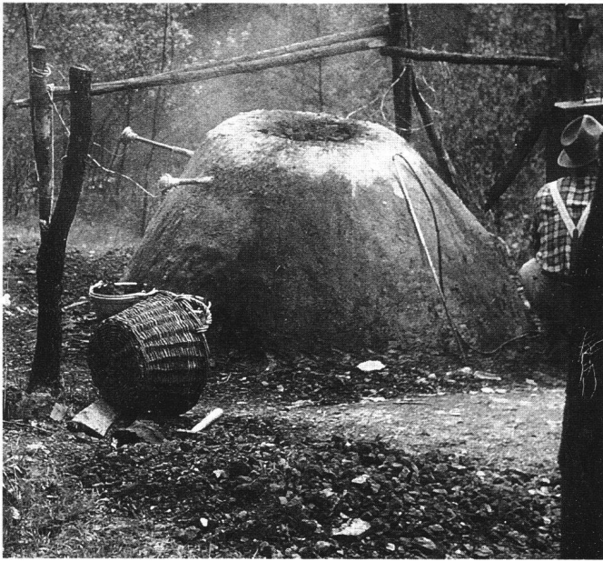
Abb. 50 Nachgebauter Rennofen im Siegerland. Durch die Rekonstruktion frühgeschichtlicher Rennfeuer und Versuche in nachgebauten Rennfeuern sowie aufgrund zahlreicher Schlackenuntersuchungen ist es möglich geworden, die Arbeitsweise der Rennfeuerleute, deren Erfolge und Misserfolge kennenzulernen.
