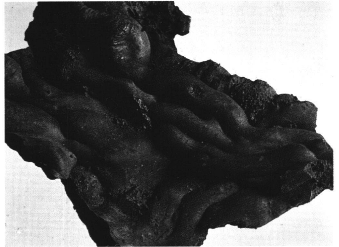
Abb. 47 Lauschlacke als Zeugnis örtlicher Eisenverhüttung in Berslingen. Verkleinert.
