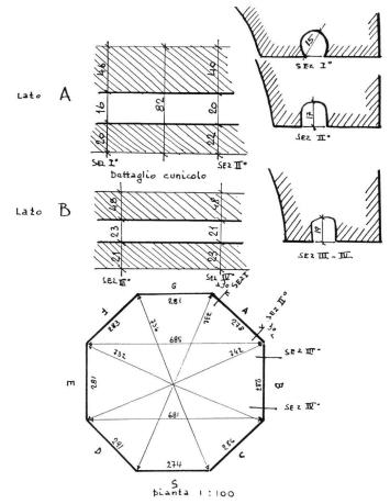
Fig. 9 Rilievo della cupola all'altezza del cunicolo, Borella, 1953, AB, 34.
