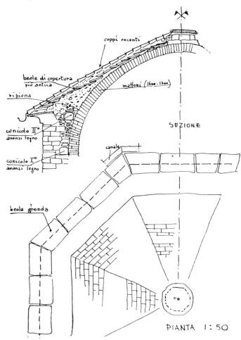
Fig. 10 Rilievo della cupola di copertura, Borella, 1954. AB, 40.
