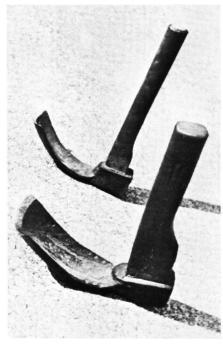
Abb. 13 Modernes Querbeil mit Hohlschneide (sog. Hohldechsel). M 1:4.
