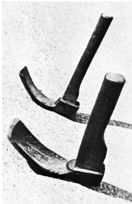
Abb.13 Modernes Querbeil mit Hohlschneide (sog. Hohldechsel). M 1 : 4.
