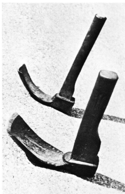
Abb. 13 Modernes Querbeil mit Hohlschneide (sog. Hohldechsel). M 1 : 4.
