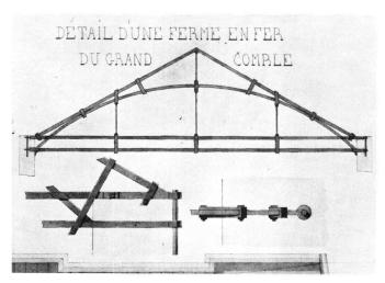
Fig. 2 Palais destiné au logement de deux familles. Détail d'une ferme métallique, 6 octobre 1856.
