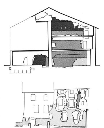
Fig. 5a+5b Schémas des trois chantiers successifs de construction de l'Hostellerie du Cerf au XIIIe siècle, voir fig. 3 et 7.
