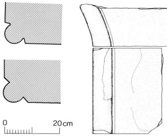
Fig. 10 L'Hostellerie du Cerf, éléments d'encadrements en molasse de baies du XIII<sup>e</sup> siècle remployés dans des maçonneries postérieures.
