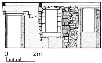
Fig. 13 L'Hostellerie du Cerf ouest, relevé de la face interne de la façade nord au 1<sup>er</sup> étage. En tramé, embrasures des fenêtres du XV<sup>e</sup> siècle; à gauche, vestiges de l'escalier menant au 2<sup>e</sup> étage.
