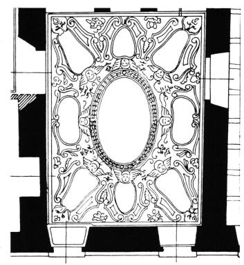
Abb. 9 Bissone. Haus Borromini-Gaggini. Flache Stuckdecke. Planaufnahme.
