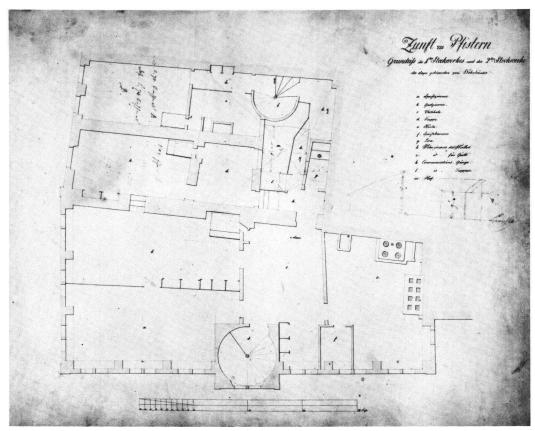
Abb. 4 Obergeschoss-Grundriss des Gesellschaftshauses zu Pfistern und 2. Stock der Nachbarhäuser von *Friedrich Studer*, um 1848, Feder koloriert. Die ursprüngliche Einteilung ist verändert (Stubenunterteilung, Speisekammereinbau in der Küche). Die Stubenwand ist um weniges ostwärts verschoben. Sie nahm im ersten Zustand wohl auf den breiten Türabsatz im Wendelstein bezug.
