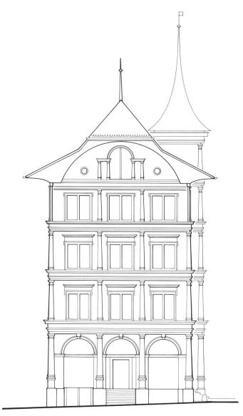
Abb. 7 Rekonstruktion der Westfassade des Gesellschaftshauses zu Pfistern (wie die Südfassade, Abb. 6). Das Bogenfeld im Ründengiebel ist aus der Fantasie gezeichnet.
