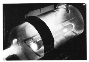
Abb. 5 Die Handfeuerwaffe während der letzten Plasmabehandlung. Mit einer geeigneten Ankoppelung wurde eine intensive Entladung durch die ganze Bohrung gezündet. Auf diese Art konnten auch aus diesem Bereich die chloridhaltigen Agglomerate entfernt werden.
