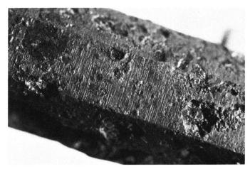
Abb. 3a Detailaufnahme der in Abb. 2a markierten Stelle. Man erkennt die scharfen Kanten der achteckigen Laufaussenseite und die feinen Spuren der vor mindestens 550 Jahren erfolgten Oberflächenbearbeitung. Diese Ritzungen sind etwa 0.1 bis 0.3 mm tief und würden bei einer konventionellen Freilegung wohl übersehen worden sein. An den «anodischen» Stellen (siehe die Vertiefungen in der Oberfläche) wurde das Eisen durch die Korrosion im Boden abgetragen.
