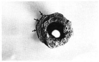
Abb. 3b Detailaufnahme des hinteren Laufendes (vgl. Abb. 2a, b) mit deutlich erkennbaren Sägespuren (siehe Pfeil).
