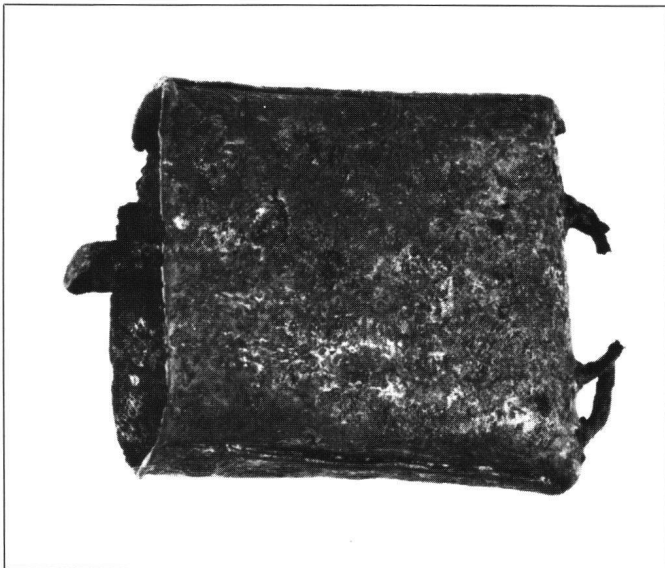
Abb. 4 Schelle aus Eisen, aus dem Mühlebachtal von Oberwil b.Zug, ca. 18. Jh. Nach der zweimaligen Plasmabehandlung ist die Oxidschicht im Hohlraum der Glocke vollständig reduziert. Dadurch ist der Klöppel wieder frei beweglich. Die seitlichen Kupferlotstellen und die verzinnete Oberfläche sind gut erkennbar.
