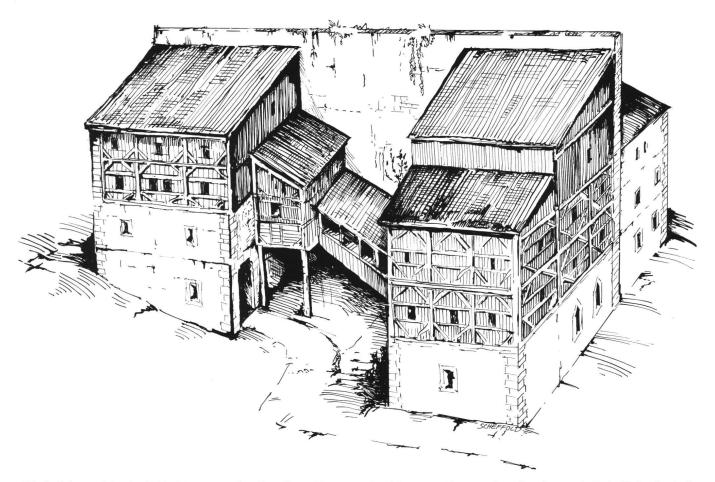
Abb. 6 Rekonstruktion des Gebäudekomplexes «Sant Küng Karlen Hus» um 1330. – Mit der gewaltigen westlichen Brandmauerscheibe im Verband steht der hofseitige Kernbau, dessen 1.+2. Obergeschoss über eine gedeckte Treppe bzw. einen zweistöckigen Laubengang erreicht werden konnte. Der gassenseitige ältere Kernbau lehnt an die jüngere Brandmauer. Das westlich gelegene «Kleine Paradies» (Kirchgasse 36) stösst ebenfalls an diese Trennwand.
