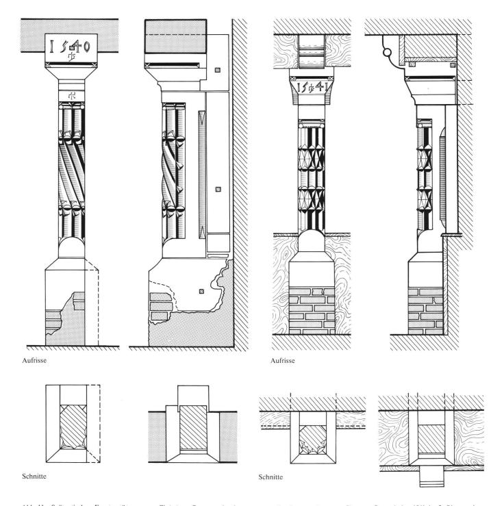
Abb. 11 Spätgotische Fensterstütze von *Christian Gyger* und einem namenlosen Steinmetzen, datiert 1540, im 1. Obergeschoss der gassenseitigen Fassade. Massstab 1:20.
