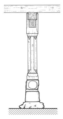
Abb. 10 Eichenstud, Sattelholz und Unterzug von 1540. Massstab 1:50.
