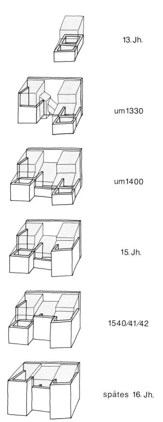
Abb. 4 Bauliche Abfolge der «Versteinerung» und der Holzaufbauten über sieben Phasen vom mittleren 13. bis zum späten 16. Jahrhundert, Blick aus Nordosten.
