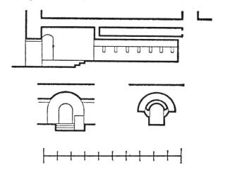
Abb. 16 Altzella (Sachsen). Steinofen-Luftheizung. Nach H. Magirius Seite 117, Abb. 13. M. 1:200.
