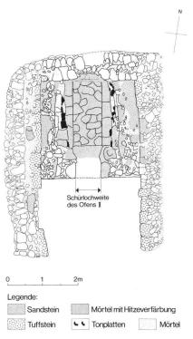
Abb. 13 Kappel am Albis. Calefactorium-Heizung. Steingerechter Grundriss des Ofens II.
