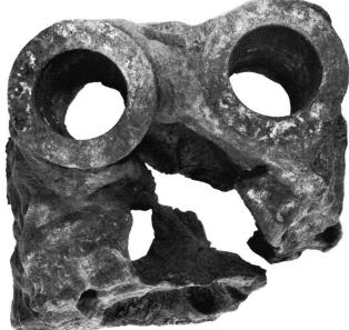
Abb. 38 Lyon (Département Rhône, Frankreich), «Rue Victor-Hugo / Rue Sainte-Hélène ». Notgrabung 1975. Gallo-römisch (wahrscheinlich 2.Jh.n.Chr.). Pumpenstück aus Eichenstamm mit zwei eingelassenen Bronzemanschetten, aus einem Schacht. Styren-Strahlenpolymerisation 1977. Breite des Objekts 35 cm.
