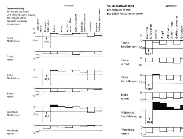
Abb. 13 Die Querschwindungen neolithischer und rezenter Proben nach verschiedenen Konservierungen.
