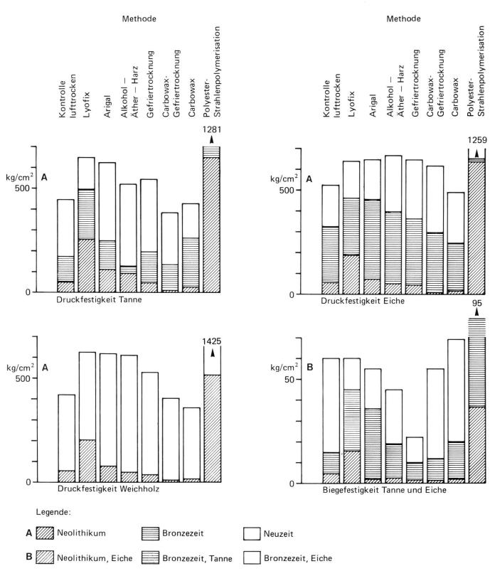
Abb. 9 Die Druck- und Biegefestigkeiten der Proben in Beziehung zu ihrem Alter, zur Holzart und zur angewandten Konservierung. Die hohen Werte bei der Polyester-Strahlenpolymerisation sind mit Zahlen angegeben, die Säulenlängen sind unvollständig. Bei der Druckfestigkeit Tanne gilt der Wert 1281 kg/cm² sowohl für bronzezeitliche als auch für neuzeitliche Proben.
