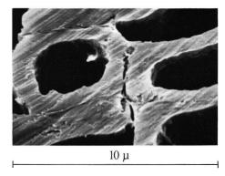
$Abb. 2 \quad Beobachtung \ von Nadelholzstrukturen \ mittels \ Makroskopie(A), \ Lichtmikroskopie(B) \ und \ Rasterelektronen mikroskopie(C).$
