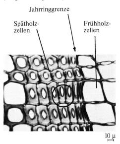
C: Rasterelektronenmikroskopische Aufnahme von Nadelholzzellwänden (Vergrösserung aus B)
