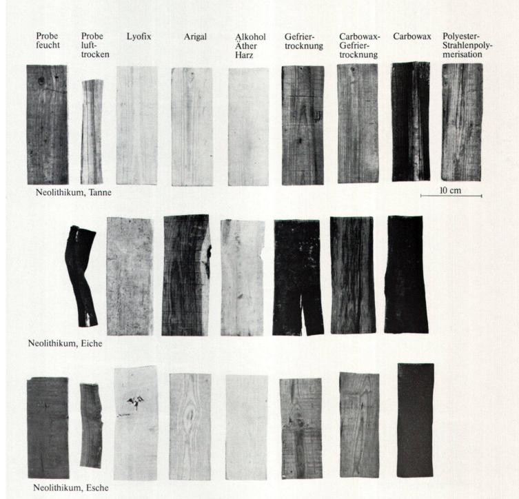
Abb. 19 Die neolithischen bodenfrischen, trockenen und konservierten Längsbretter (Form 3).
