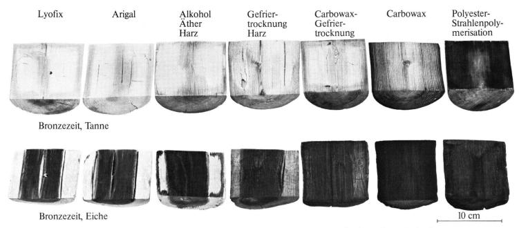
Abb. 8 Längsschnitte durch Holzrugel zeigen die Tiefenwirkung der verschiedenen Methoden in größeren Probenkörpern.
