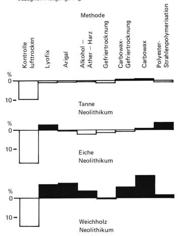
Abb. 12 Die Längsschwindung neolithischer Proben nach verschiedenen Konservierungen. Schwarze Flächen entsprechen Quellungen.
