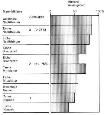
Abb. 6 Wassergehalt und Abbaugrad der einzelnen Materialklassen (Holzarten verschiedener Zeiten).
