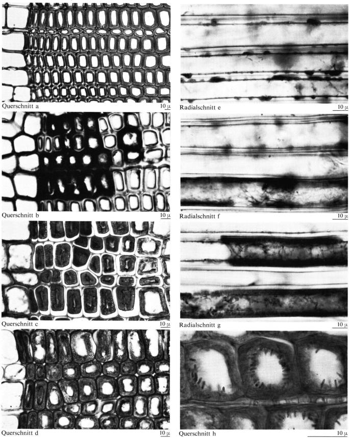
Abb. 5 Mikroskopische Bilder der Abbauerscheinungen in wassergelagertem Nadelholz.
