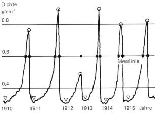
Abb. 7 Vergleichende Darstellung von Jahrringabfolge mit Fotografie, Röntgenbild und entsprechender Holzdichtekurve. Aus der Dichtekurve werden zur Auswertung 5 verschiedene Parameter ausgewählt.
