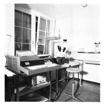
Abb. 5 Ansicht der Meßapparatur im Labor, rechts der Meßtisch mit kleinem Drehgeber, links daneben der Kleincomputer, darunter Digitalisiergerät mit Speicher.
