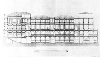
Fig. 10 J.A. Froelicher et Grisart: Coupe longitudinale des Galeries du Commerce et de l'Industrie, Paris. D'après Normand aîné, IIe partie [1849]
